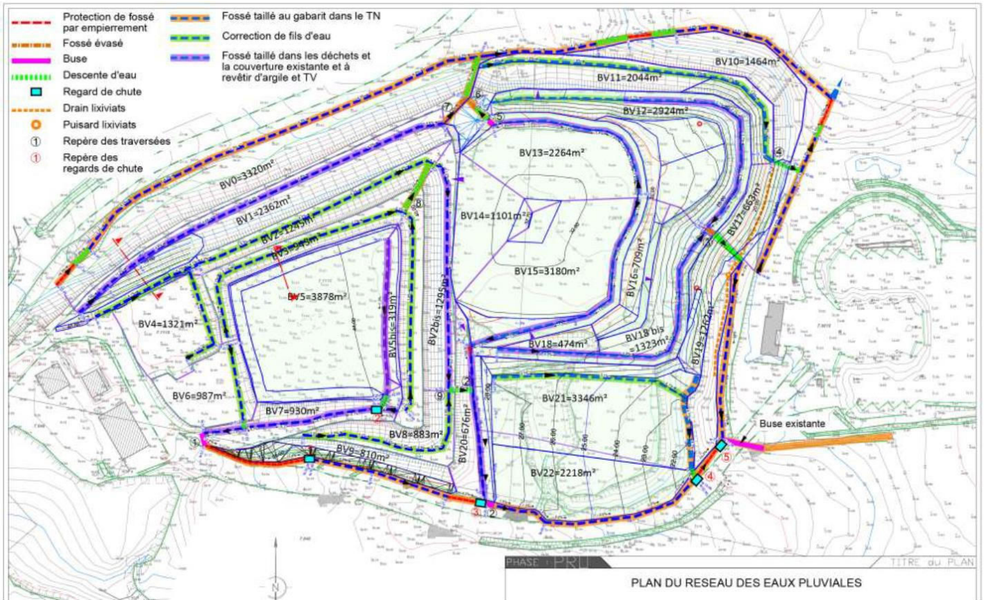
Figure 48 : Plan de schéma des eaux pluviales sur l'ancienne décharge d'Hamaha (Source : CCTP du lot 1 des travaux de réhabilitation de la décharge)
